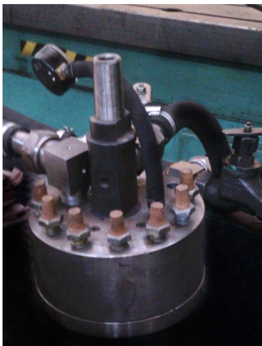
Инструмент для осуществления пневмовибродинамической обработки плоских поверхностей
