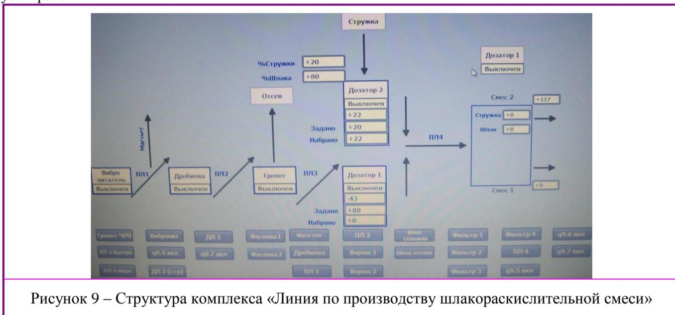
Рисунок 9 – Структура комплекса «Линия по производству шлакораскислительной смеси»
