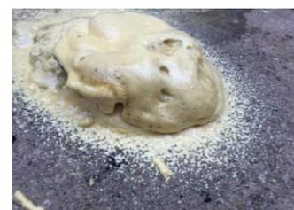
**Тушение производится с использованием переносной установки для подачи трудногорючего ППУ**
