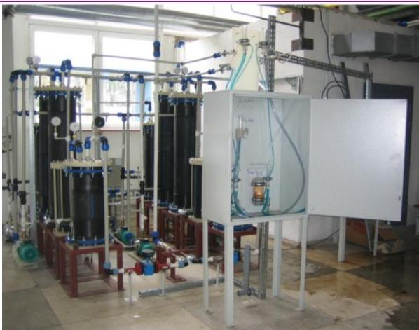
Рисунок 12 – Автоматизированная модульная мембранная установка
