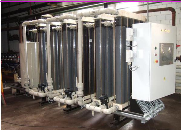
Рисунок 13 – Автоматизированная модульная установка для очистки воды от ионогенных органических соединений
