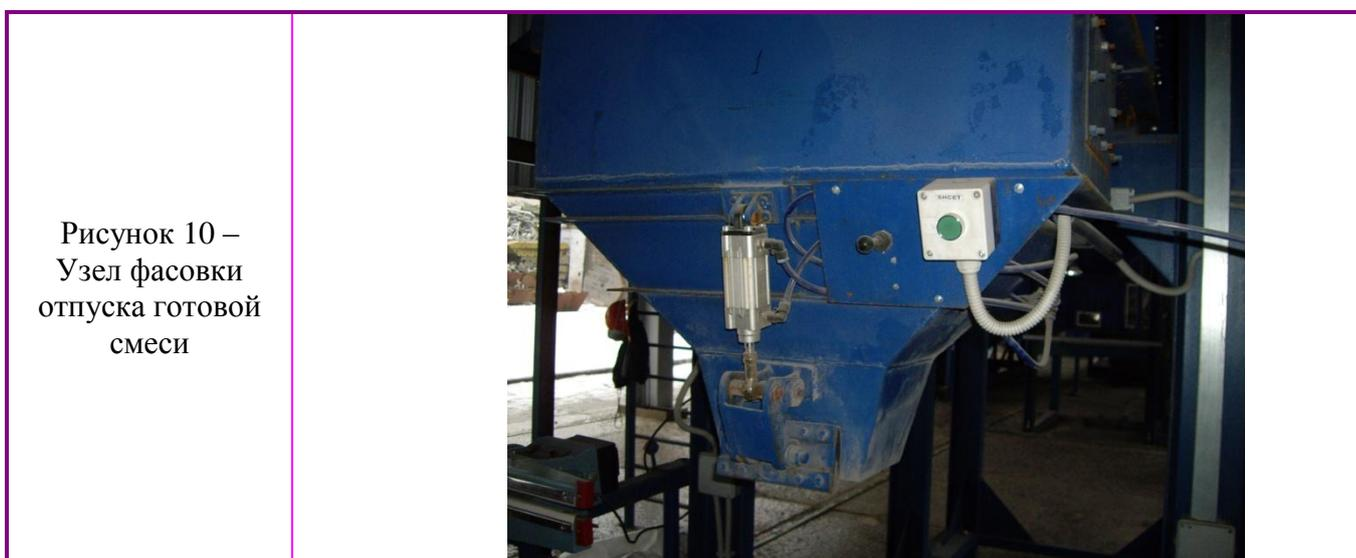
Рисунок 10 – Узел фасовки отпуски готовой смеси
