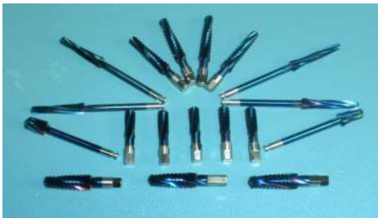
Рисунок 62 – Сверла с коррозионностойким и износостойким комбинированным многослойным покрытием ( Cr - CrN - (Cr + 5\% \text{ УДА}) )
