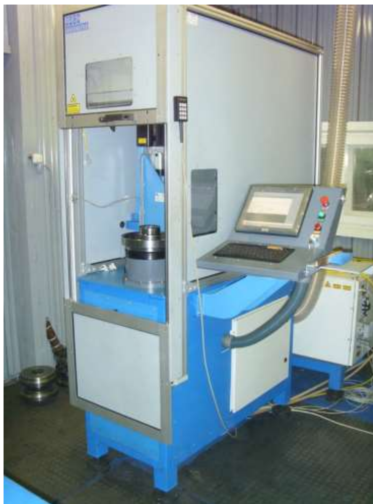
Рисунок 59 – Установка для лазерной закалки деталей автомобилей БелАЗ
