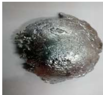
б – фильтрат на основе олова и свинца, содержащий до 10% меди
