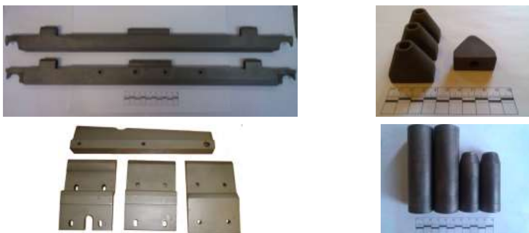
Рисунок 56 – Внешний вид изделий различного функционального назначения, упрочненных в среде Besto-Bor
