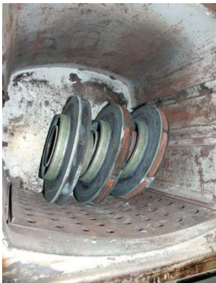
Рисунок 58 – Рабочие колеса нефтеперекачивающих насосов, упрочненные газопламенным напылением
