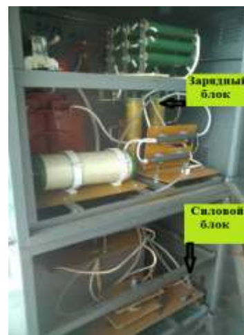
Рисунок 35 – Внешний вид основных элементов устройства электрогидравлической обработки, преобразующего энергию в импульсы тока микросекундной длительности
