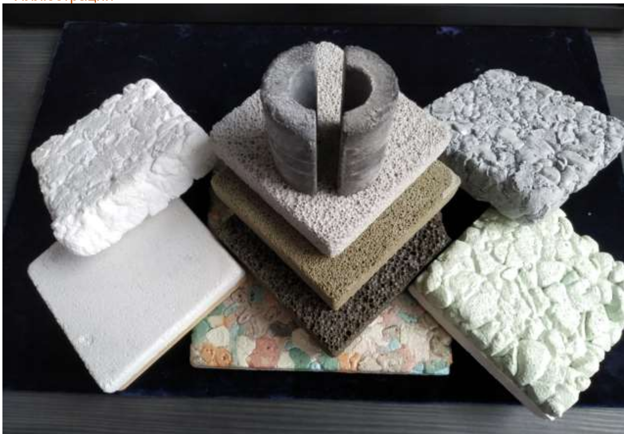
Рисунок 12 – Образцы силикатных пеностекломатериалов, полученные в Проблемной НИЛ перспективных материалов ГГУ имени Ф. Скорины
