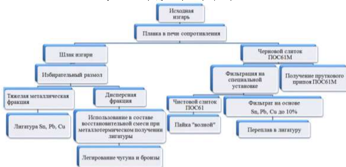
Рисунок 23 – Технологическая схема переработки оловянно-свинцовой изгары
