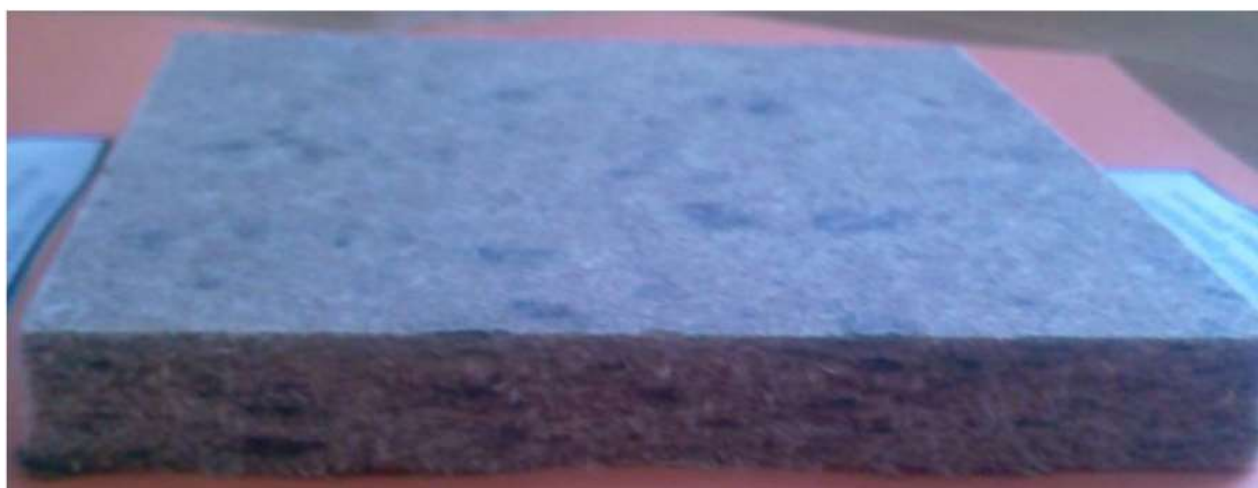
Рисунок 45 – Органо-синтетические волокнистые плиты (ОСВПт) мокрого способа производства с использованием коротковолокнистых текстильных отходов
