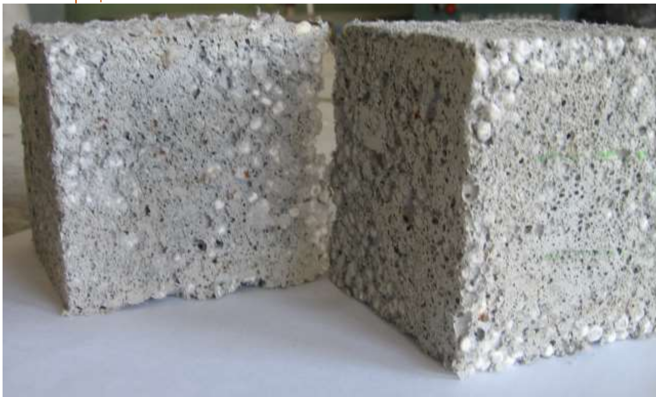
Рисунок 5 – Полистиролфибропенобетон. Внешний вид материала
