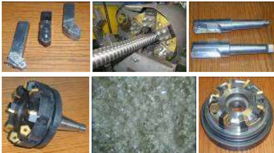
Рисунок 67 – Сборные металлорежущие инструменты с тонкими демпфирующими покрытиями на базовых поверхностях
