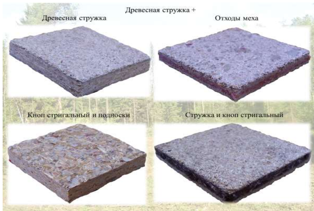
Рисунок 48 – Конструкционные плиты из отходов
