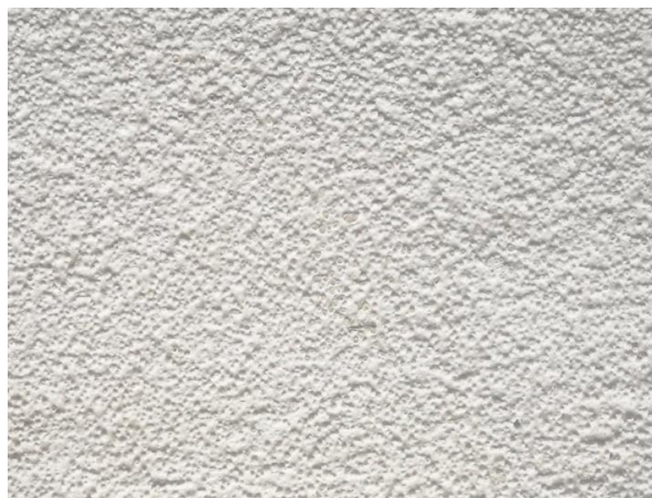
Рисунок 11 – Структура санирующей теплоизоляционной штукатурки
