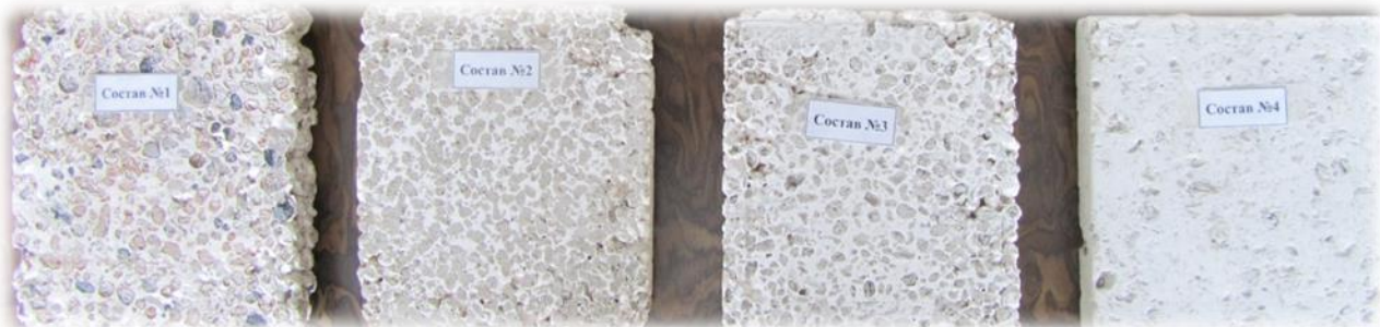
Рисунок 4 - Конструкционные и теплоизоляционные материалы на основе отходов производства бумажно-картонных предприятий
