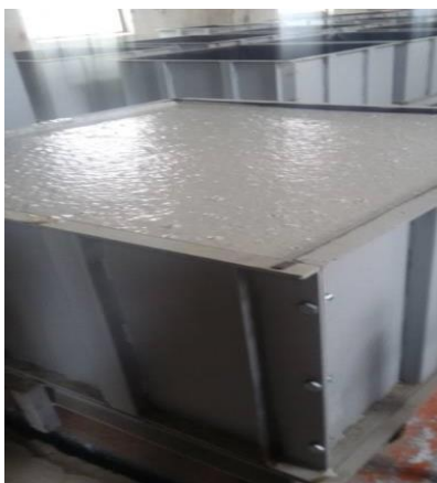
Рисунок 5 – Технология получения теплоизоляционных материалов на основе вспененного жидкого стекла и волокнистых техногенных отходов
