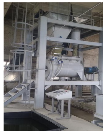
Рисунок 5 – Технология получения теплоизоляционных материалов на основе вспененного жидкого стекла и волокнистых техногенных отходов
