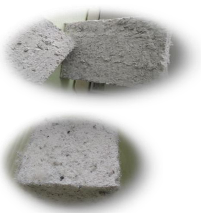
Рисунок 5 – Технология получения теплоизоляционных материалов на основе вспененного жидкого стекла и волокнистых техногенных отходов
