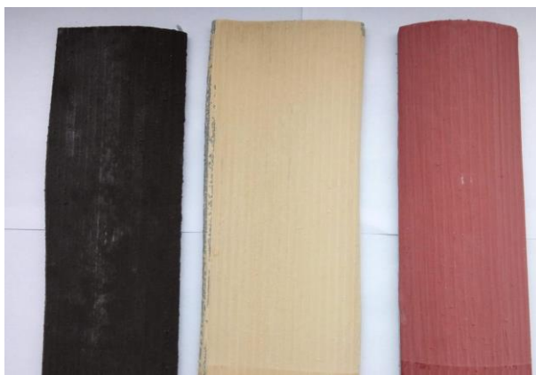
Рисунок 9 – Окрашенные хризотилцементные листы
