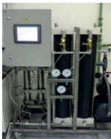
Рисунок 33 – Автоматизированная установка микрофильтрационной очистки воды
