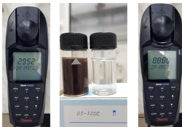
Рисунок 45 – Показатели мутномера до и после обработки сточных вод химреагентами
