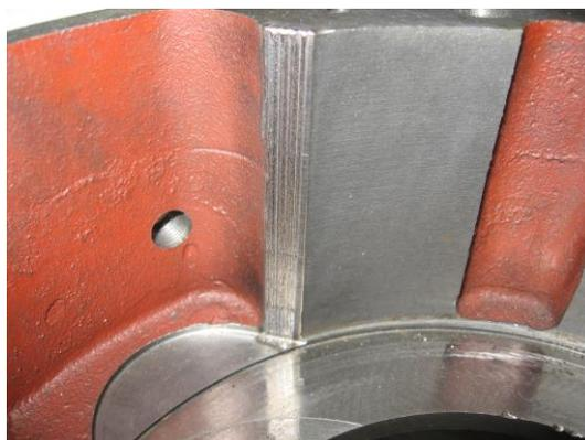
Рисунок 13 – Корпус тормоза трактора, упрочненный лазерной закалкой
