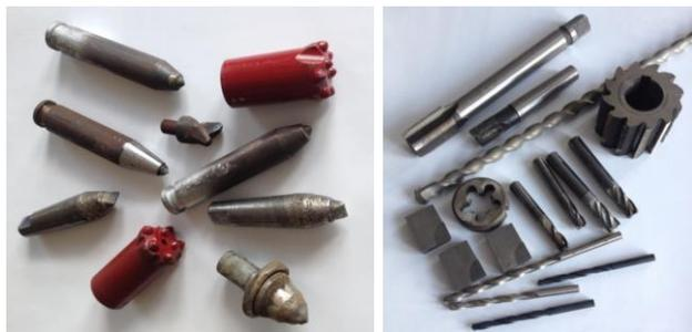
Рисунок 19 – Инструмент для бурения и металлорежущий инструмент
