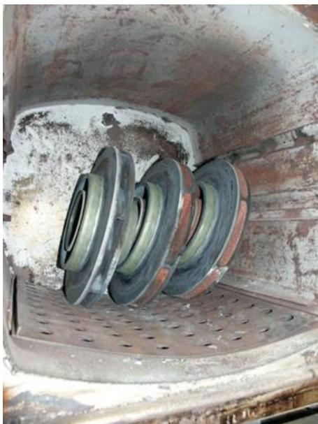
Рисунок 11 – Рабочие колеса нефтеперекачивающих насосов, упрочненные газопламенным напылением
