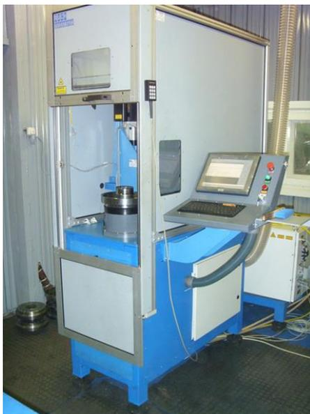
Рисунок 12 – Установка для лазерной закалки деталей автомобилей БелАЗ
