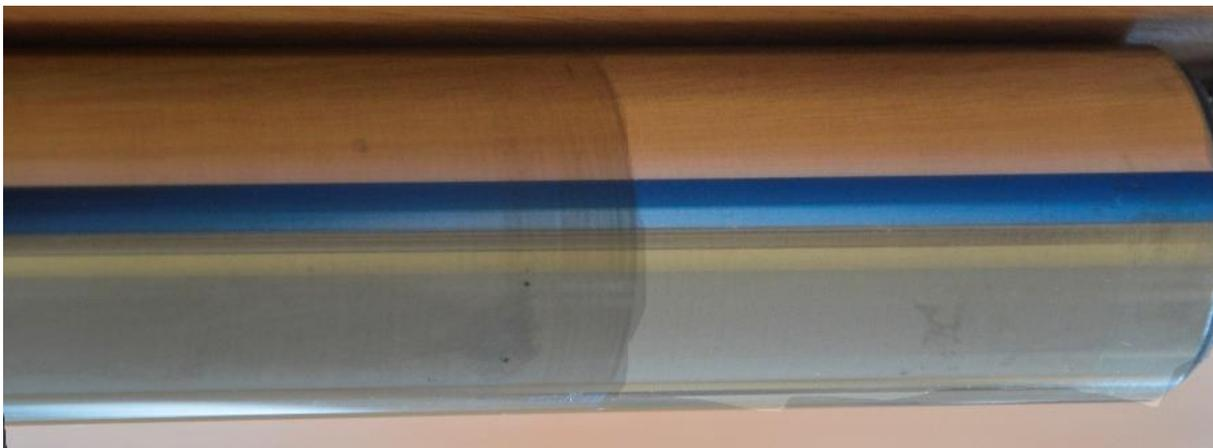
Рисунок 16 – Участок плунжера насоса, подвергнутый магнитно-абразивной обработке с использованием борированного порошка на основе железа фракции 0,063...0,080 мм (правая часть плунжера)
