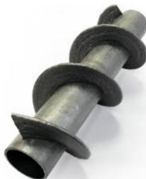
Рисунок 7 – Элемент шнека, выполненный из высокопрочных материалов по технологии WAAM
