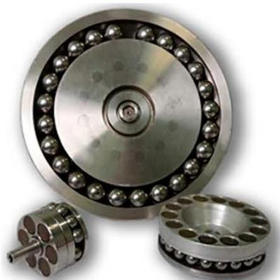
Рисунок 4 – Инструменты, обеспечивающие упрочнение наружных, внутренних поверхностей вращения и плоских поверхностей различных деталей
