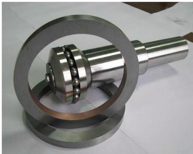
Рисунок 9 – Фотография упрочнённых колец и инструмента для совмещенного магнитно-динамического накатывания
