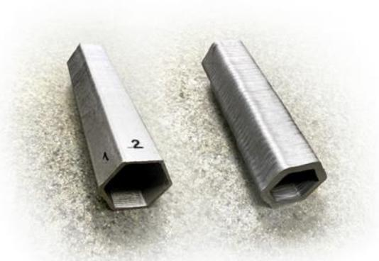
Рисунок 6 – Изделия из алюминиевых сплавов *Al-Mg-Cu*, полученные по технологии WAAM
