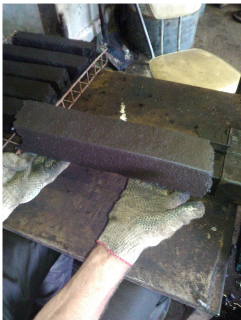
Рисунок 27 – Топливо, получаемое с использованием нефтесодержащих и растительно-древесных отходов на шнековой установке брикетирования
