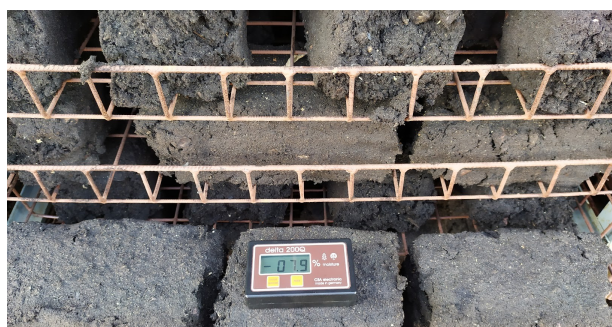
Рисунок 23 – Измерение влажности в контейнере
