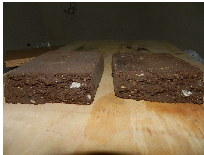
Рисунок 26 – Внешний вид структуры топлива с использованием ОСВ
