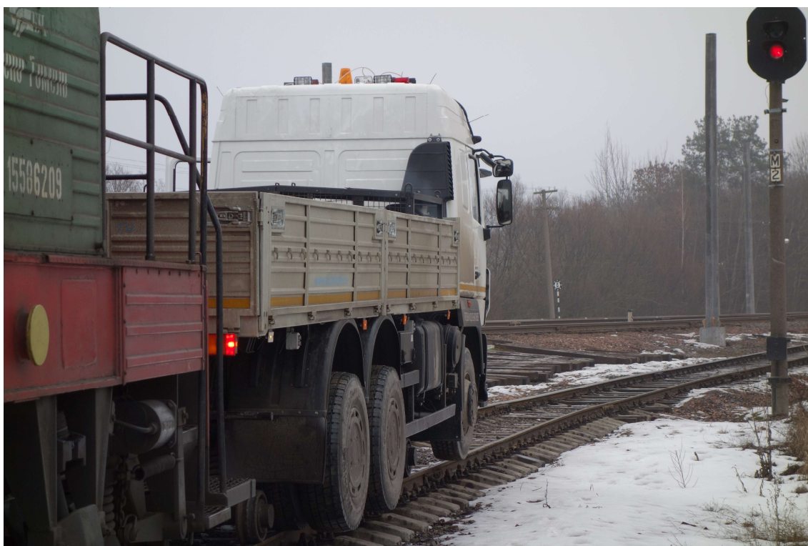
Рисунок 43 – Универсальная путевая машина на шасси MA3-6303 и MA3-6312
