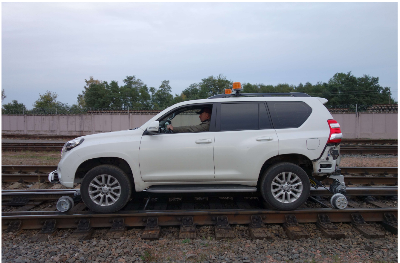
Рисунок 44 – Дрезина на шасси УАЗ-Пикап и Toyota Land Cruiser Prado
