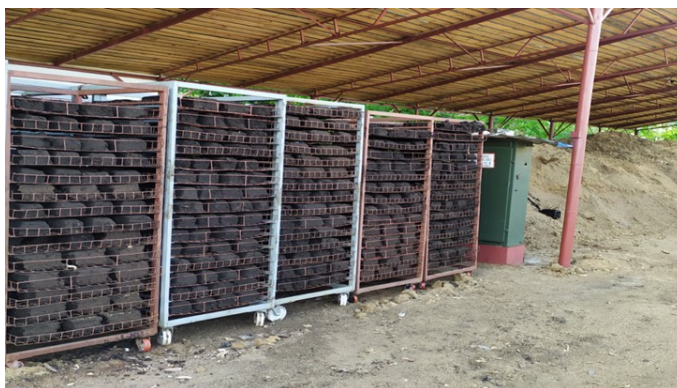
Рисунок 21 – Вид сушки топлива в теплые время года под навесом
