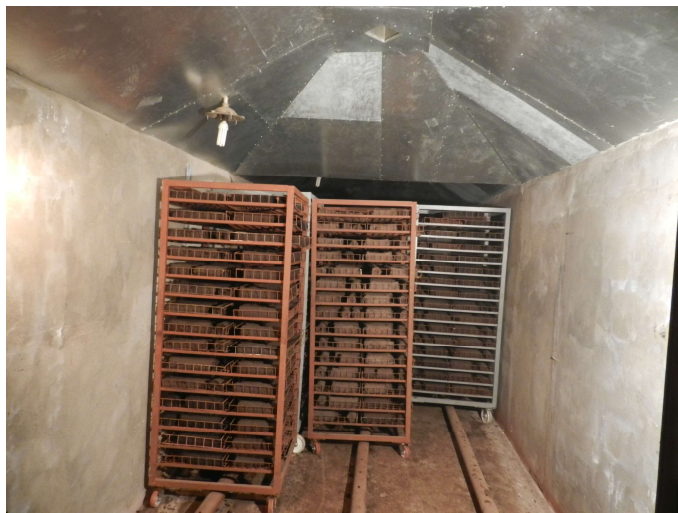
Рисунок 29 – Сушка брикетов в сушильной камере в контейнерах
