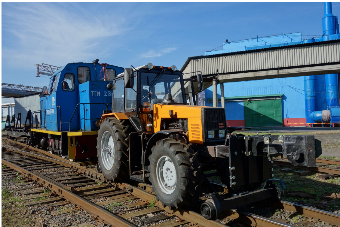
Рисунок 45 – Тяговый модуль вагонов на шасси МТ3-1221
