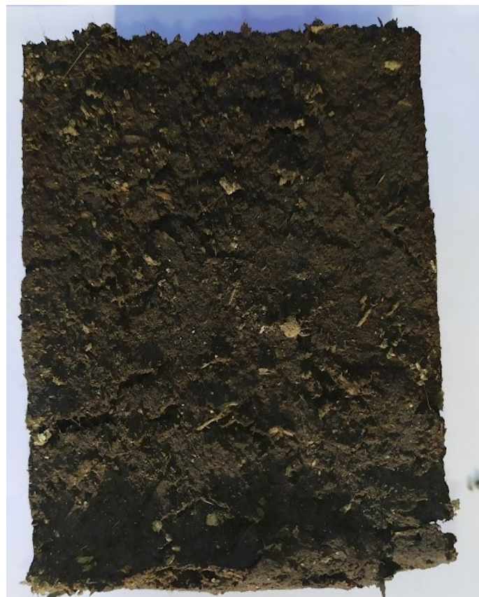
Рисунок 26 – Внешний вид структуры топлива с использованием ОСВ
