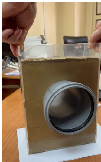
Рисунок 37 – Стабилизация грунта с образованием гомогенной структуры
