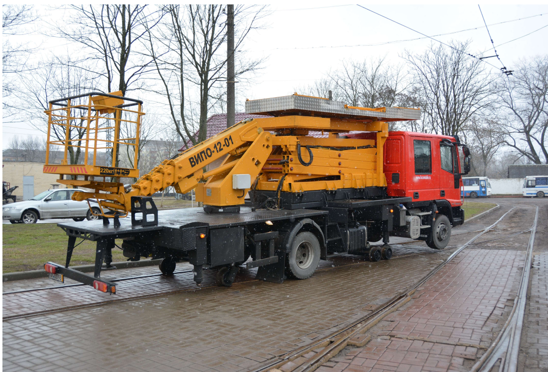
Рисунок 41 – Машина для строительства и текущего содержания контактной сети на шасси Iveco
