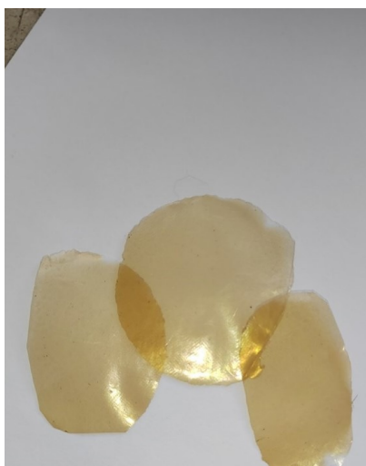
Рисунок 10 – Пленки полиэтилена с нанесённым слоем лигнина
