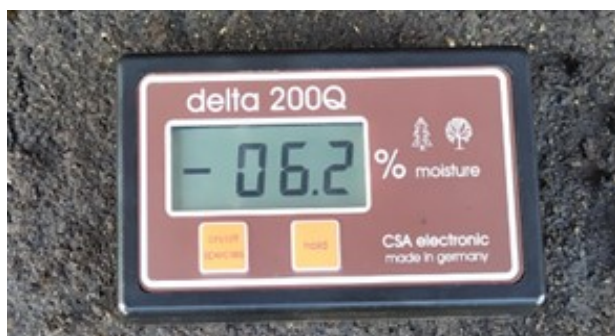
Рисунок 22 – Влажность топлива при атмосферной сушке
