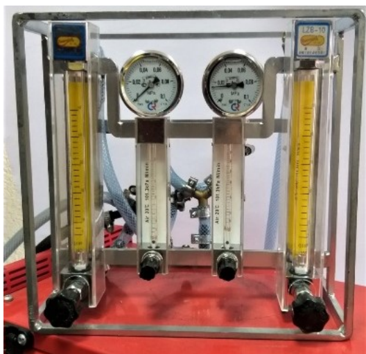
Рисунок 1 – Установка для смешивания трехкомпонентной защитной газовой среды
