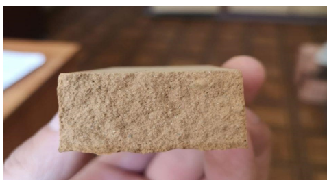
Рисунок 36 – Внешний вид грунта с модификатором
