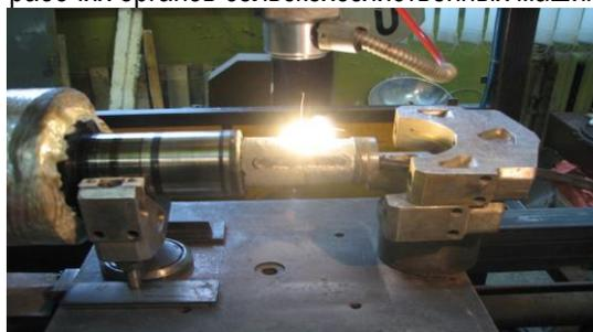
Рисунок 50 – Процесс лазерной наплавки конической поверхности ротора редуктора турбины для Осиповичской мини-ТЭЦ
