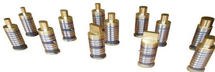
Рисунок 67 – Пробивные пуансоны с покрытиями nc-ZrCN/a-C
