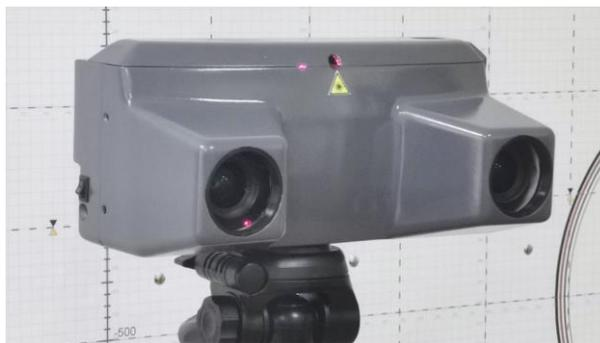
Рисунок 51 – Программно-аппаратный комплекс криминалистического назначения (внешний вид)
