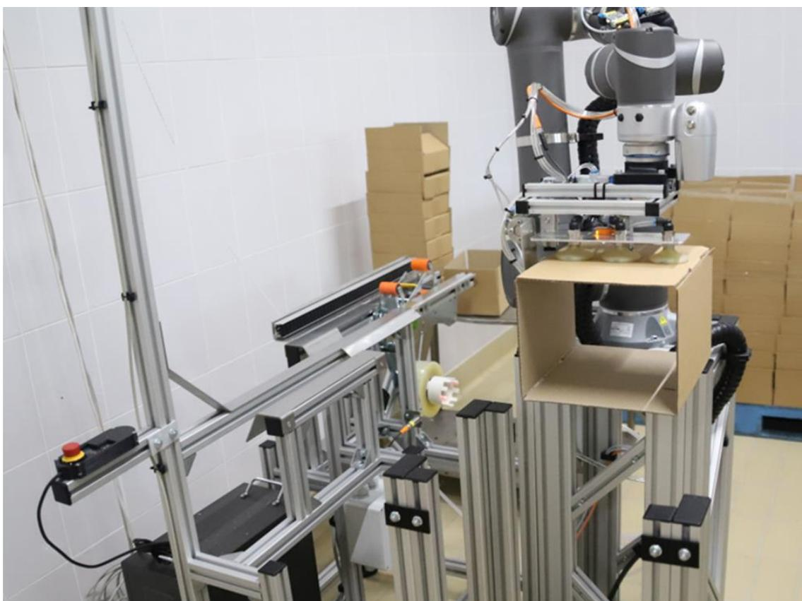
Рисунок 31 – Формирование коробов с помощью коллаборативного робота
