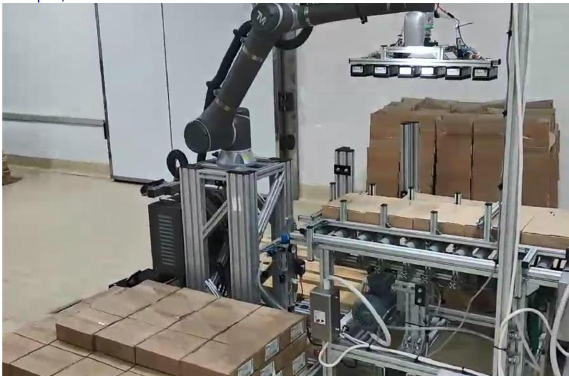
Рисунок 28 – Пример паллетайзера на основе коллаборативного робота *TechMan*
