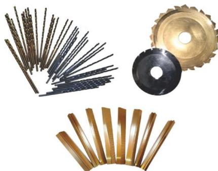
Рисунок 64 – Многокомпонентные покрытия с использованием металлических катодов (Ti, Zr, Cu, Cr, Al и др.) осаждения в среде реакционных газов при сепарации плазменного потока
