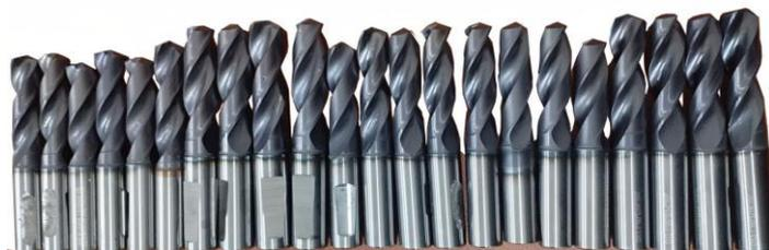
Рисунок 66 – Твёрдосплавные сверла с покрытиями AlTiN
