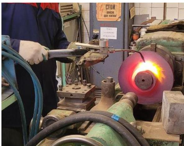
Рисунок 23 – Операция оплавления после напыления для порошковых самофлюсующихся материалов
