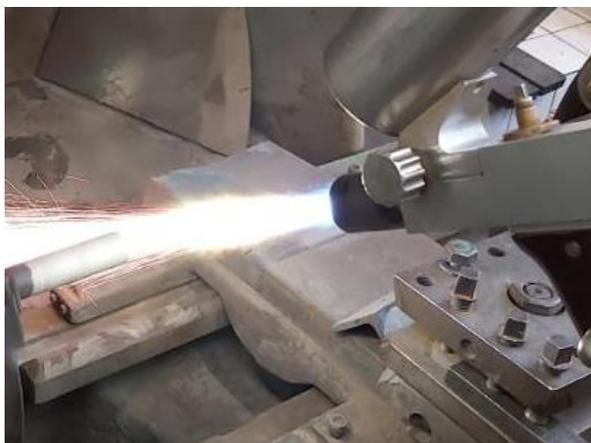
Рисунок 22 – Газопламенное напыление
