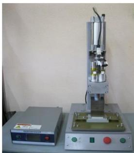
Рисунок 14 - Установка для ультразвуковой сварки полимерных изделий
