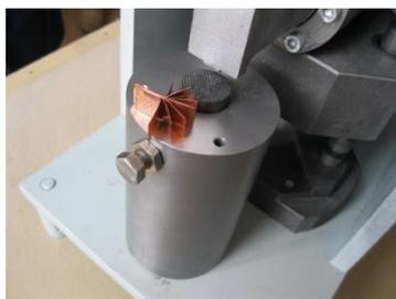
Рисунок 15 – Установка для ультразвуковой сварки металлических изделий внахлест
