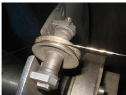
Рисунок 4 – Узел обводного ролика
