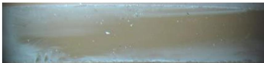
Рисунок 39 – Результат лазерного термораскалывания кристаллов кварца
