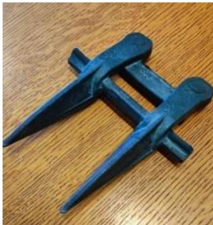
Рисунок 3 – Поковка «Палец сдвоенный»
