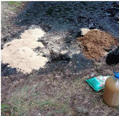
Рисунок 24 – Обработка точек локального мониторинга на объекте аварийного разлива мазута для выяснения наиболее эффективной комбинации бактериального консорциума.
