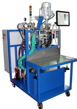
Рисунок 6 – Дозатор полимерных двухкомпонентных систем 2ДК для импульсной заливки изделий эпоксидным пенопластом по двухкомпонентной системе с замешиванием фреона в смолу
