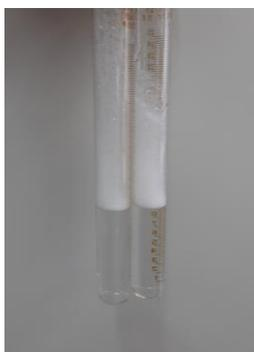
Рисунок 11 – Пробирки через полторы минуты после встряхивания. В правую пробирку пеногаситель добавлен сразу после встряхивания. В ней высота пены уменьшилась в два раза.
