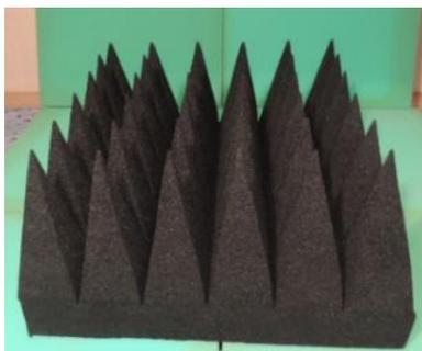
Рисунок 8 – Наноструктурированное широкополосное радиопоглощающее покрытие
