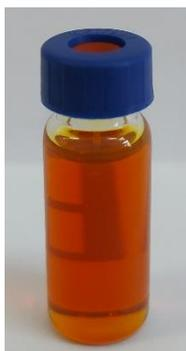
Рисунок 1 – Тяжёлая фракция после гидроочистки с применением алюмоникельмолибденового катализатора
