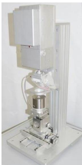
Рисунок 53 – Аппаратно-программный комплекс для измерений элементного состава низколегированных сталей и сплавов
