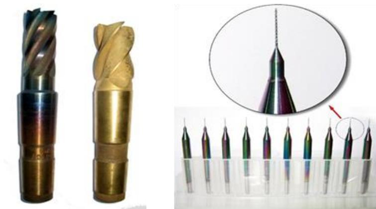
Рисунок 58 – Сверла, фрезы и микросвёрла с нанесенным покрытием
