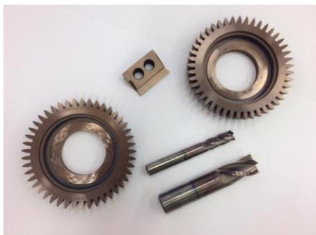
Рисунок 65 – Изделия, упрочнённые вакуумно-плазменными покрытиями
