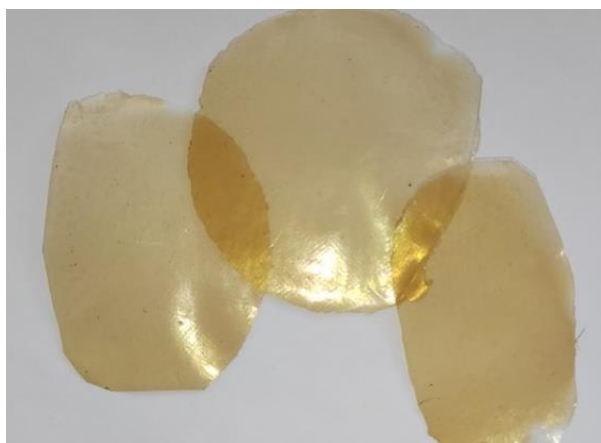
Рисунок 7 - Пленки полиэтилена с нанесённым слоем лигнина
