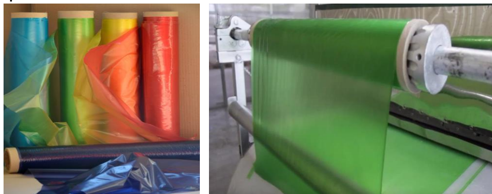
Рисунок 2 - Рулонный упаковочный материал, полученный на опытно-промышленной установке
